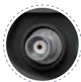
BNC, подключение pH или ORP электрода
