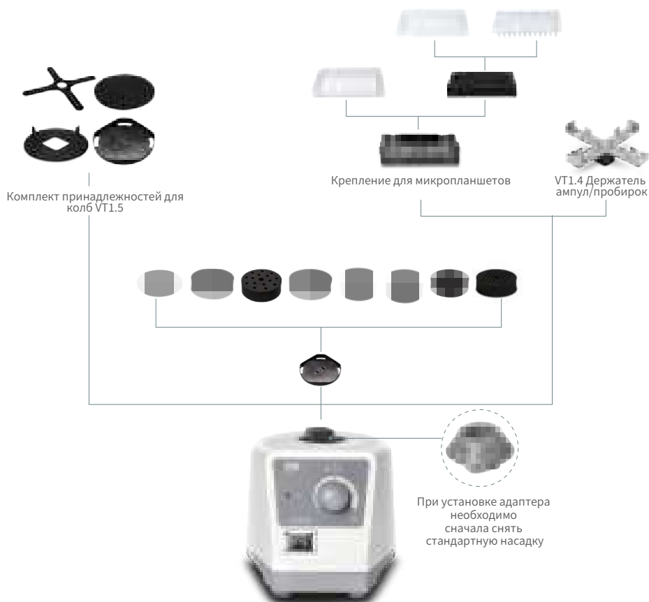
Схема использования универсальной платформы VT1.3 с адаптерами для пробирок
